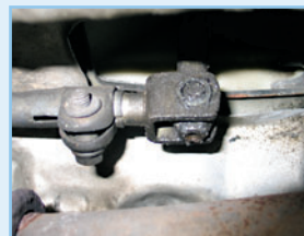
Verschlossene Schaltgestänge: böse Getriebebeschäden drohen
