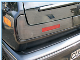
Grauer Star: Die Rücklichter werden grau und milchig
