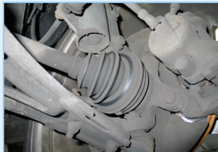
Antriebswellen: Solange die Gummimanschetten intakt sind, halten die Gelenke ewig
