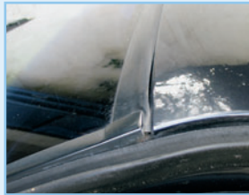
Gefahr: Unter der geklebten Scheibe blüht es unerkannt
