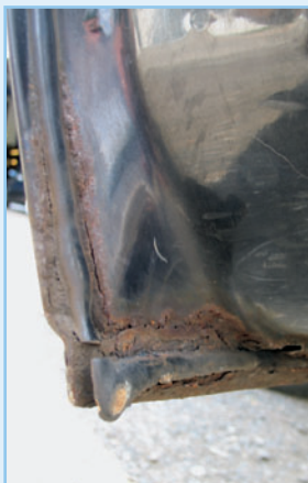
Der Rost-Klassiker: gammelnde Türfalzen
