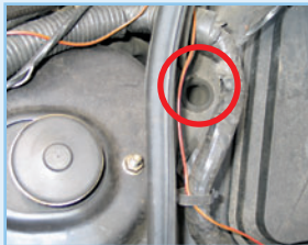
Ist der Ablauf zu, kann Wasser ins Steuergerät laufen!
