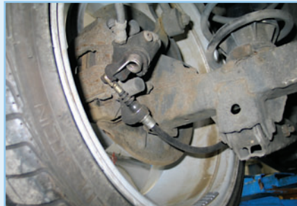
Chronisch krank und teuer: Die hinteren Bremssättel und Handbremsseile gammeln fest
