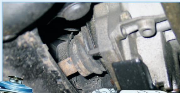
Antriebswellen: Solange die Gummimanschetten intakt sind, halten die Gelenke ewig
