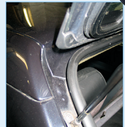
Wasser marsch: Durchlässige Dichtungen ziehen Nässe und Rost im Heck nach sich
